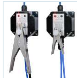
As estações indicadoras de eficiência energética externa do Earth-Rite MULTIPOINT II fornecem indicação de status do aterramento para cada canal individual. As luzes de atenção verdes em LED brilham de forma intermitente quando uma conexão de aterramento positiva é feita. As estações indicadoras podem ser montadas em todas as áreas ATEX/IECEx e em todos os locais de classes e divisões classificados como perigosos. Além da opção padrão GRP, as estações indicadoras podem ser especificadas em aço inoxidável.
