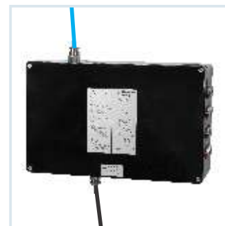
A fonte de alimentação de 230 V/110 V CA do Earth-Rite MULTIPOINT II comporta 11 (onze) contatos sem tensão SP/DT. 8 desses contatos interagem com cada canal de aterramento monitorado, 2 fornecem a função de canal agrupado e 1 relé fornece uma função de saída de redundância à prova de falhas. A fonte de alimentação pode ser instalada nas áreas e zonas 2/21 e Classe I, Div.2, Classe II, Div.1, Classe III, Div.1. A fonte de alimentação pode ser alojada em GRP ou compartimentos de aço inoxidável.
