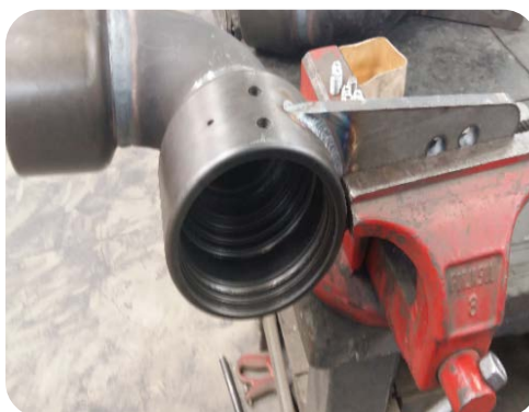
Foto 2. Fijar la junta hembra a una tornillo.
