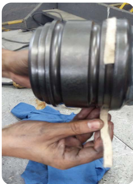
Foto 7. Limpie el guardapolvo y junta macho.
