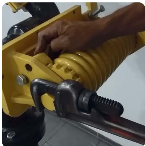
Foto 12. Posicione la traba en el plato regulador.
