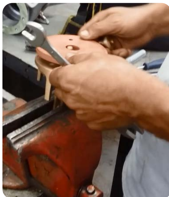
Foto 10. Retire el sello para el cambio.
