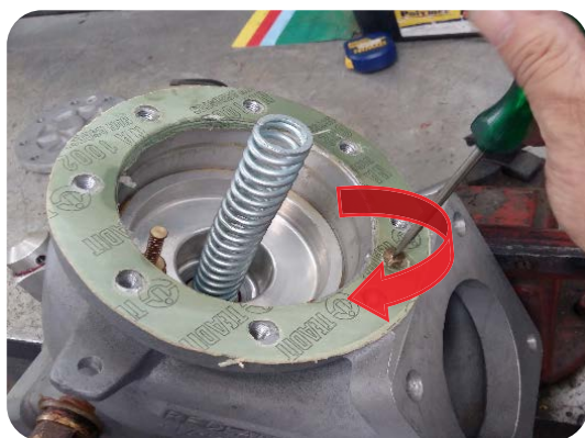
Foto 12. Sentido del reloj para corte más lento.
