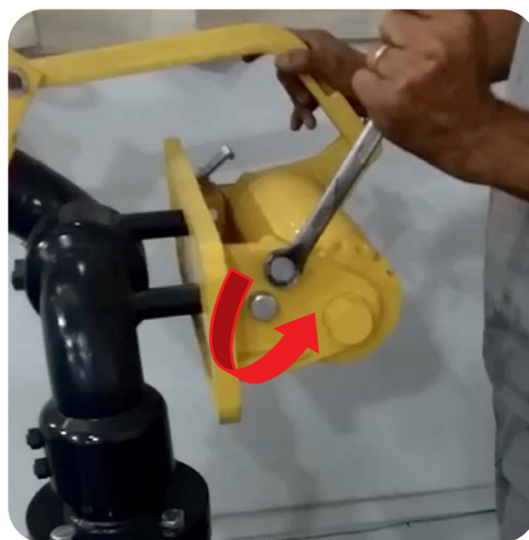
Foto 7. Afloje el tornillo superior.
