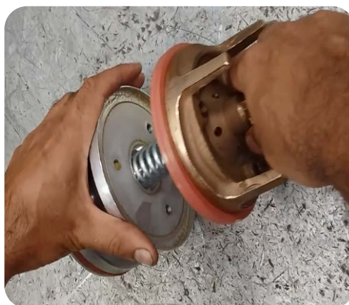
Foto 9. Tire la guía, separando del pistón.
