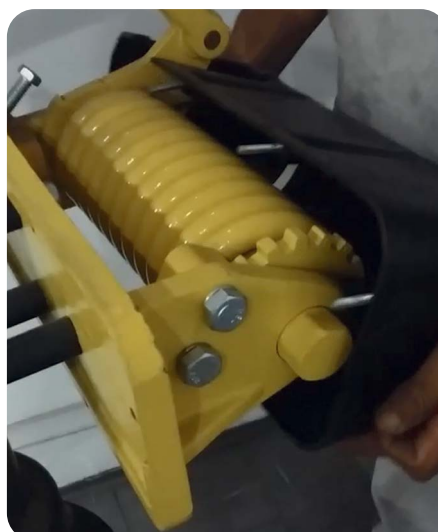
Foto 2. Retire la tapa protectora.
