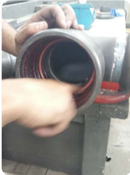
Foto 5. Coloque el anillo dentro de la junta hembra.
