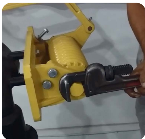
Foto 8. Fijar el sextavado del plato con el llave inglesa.
