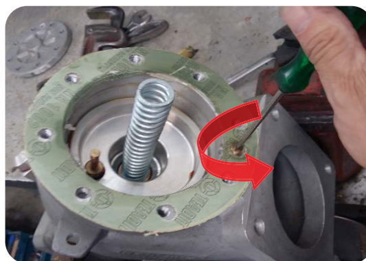
Foto 13. Gire en sentido contrario al del reloj para el corte más rápido.
