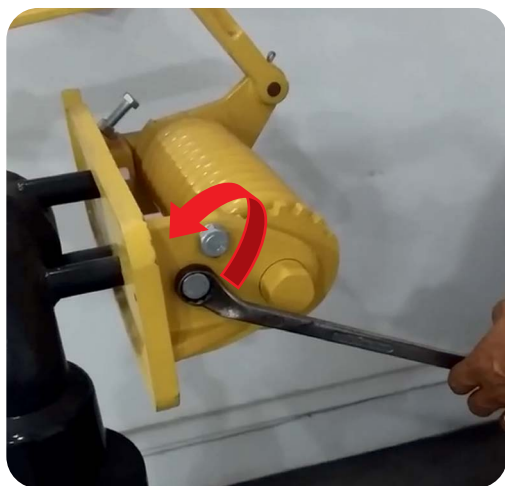
Foto 6. Afloje el tornillo inferior.
