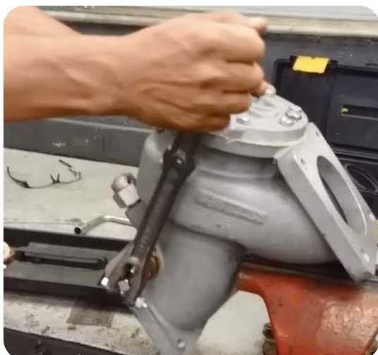
Foto 1. Accione la válvula a través de la palanca para exhalar el aire aprisionado en el cilindro.
