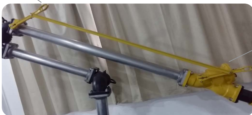
Foto 18. Barra fijada en la palanca de la válvula hasta la palanca de control remoto.
