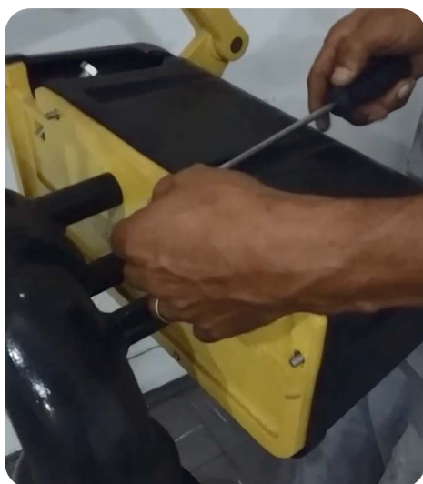
Foto 1. Destornille la tapa protectora.
