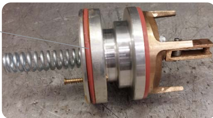
Foto 11. Realice el cambio del anillo o'ring después del remontaje.
