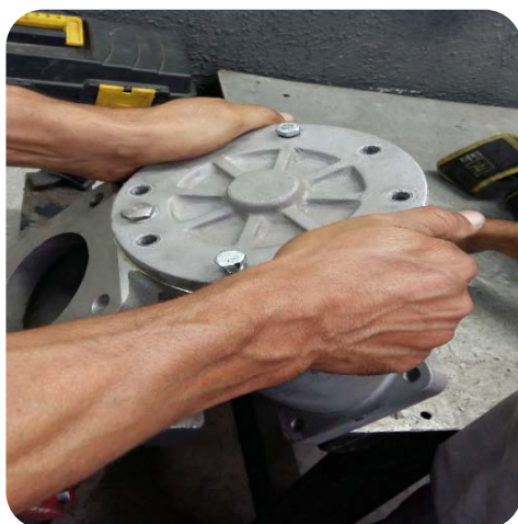
Foto 3. Retire todos los tornillos de la tapa de la válvula.
