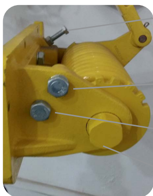
Foto 5. Vista lateral de la base del resorte.
