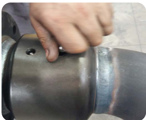
Foto 11. Inserte las esferas en el canal.
