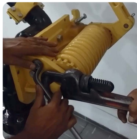
Foto 13. Coloque los tornillos de fijación.
