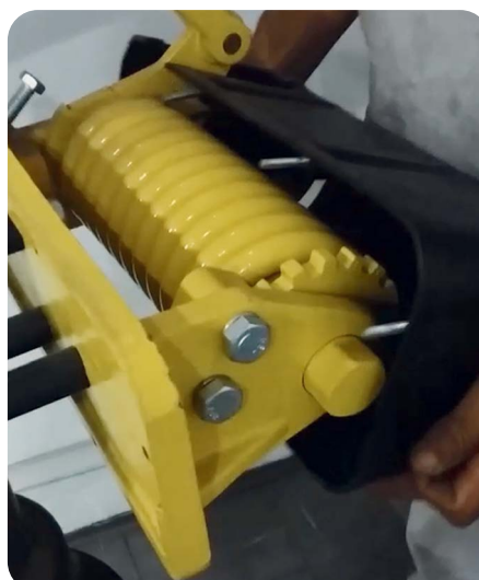
Foto 2. Retire la tapa protectora.
