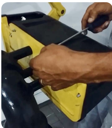
Foto 1. Destornille la tapa protectora.
