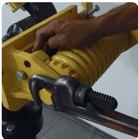
Foto 12. Posicione la traba en el plato regulador.
