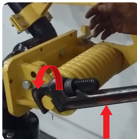
Foto 11. Para menor torsión, gire en el sentido contrario al del reloj.
