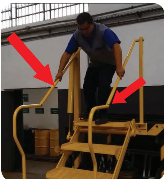
Foto 13. Presionando el pedal para recoger la escalera.
