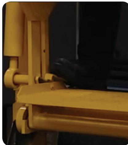
Foto 9. Accionamiento del pedal.
