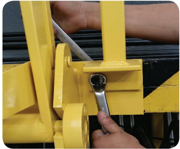
Foto 2. Fijación de la base al lado derecho.
