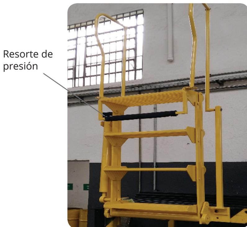
Foto 15. Posición correcta para mantenimiento del resorte.
