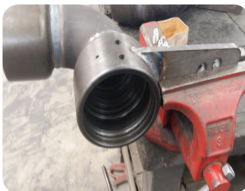
Foto 2. Fijar la junta hembra a una tornillo.
