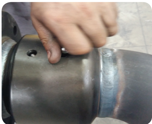
Foto 11. Inserte las esferas en el canal.
