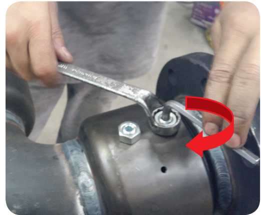
Foto 14. Gire las tuercas sobre los tornillos para trabarlos.
