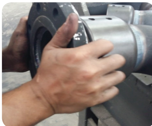
Foto 10. Gire la junta macho en el sentido del reloj.
