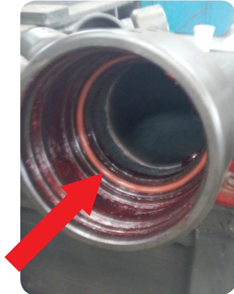
Foto 6. El anillo O'ring debe quedar ajustado en la junta hembra.
