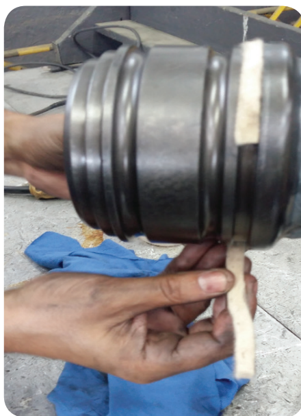
Foto 7. Limpie el guardapolvo y junta macho.
