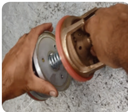
Foto 9. Tire la guía, separando del pistón.
