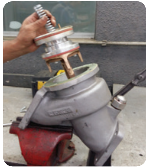
Foto 6. Retire el subconjunto del pistón cuidadosamente de la válvula.
