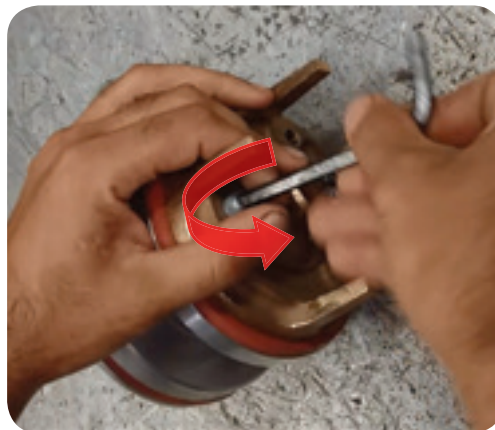
Foto 8. Gire la llave allen en el sentido contrario al del reloj.
