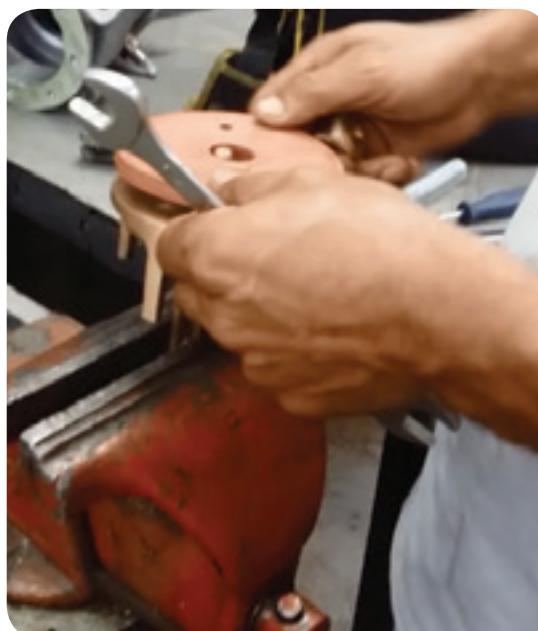
Foto 10. Retire el sello para el cambio.
