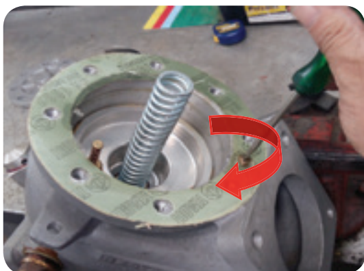
Foto 12. Sentido del reloj para corte más lento.
