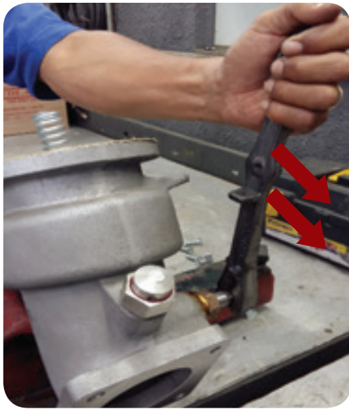
Foto 5. Accione la palanca hacia adelante y libere el conjunto de pistón.
