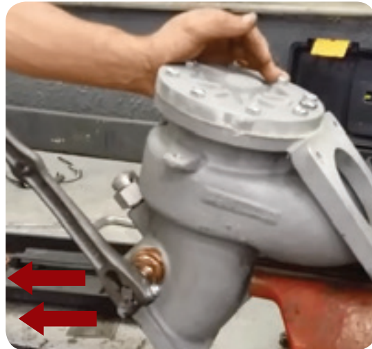
Foto 2. Al tirar de la palanca hacia atrás, el pistón abre el pasaje para el flujo.
