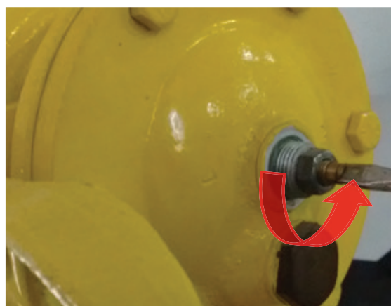
Foto 17. Gire en sentido contrario al del reloj para el corte más rápido.
