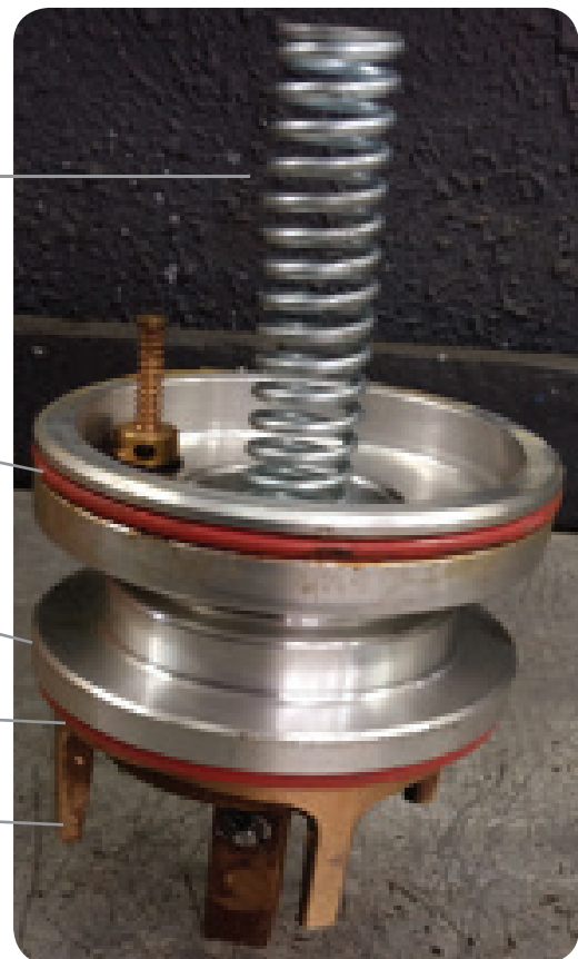
Foto 7. Pistón de accionamiento
