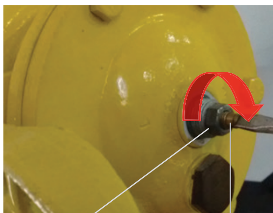
Foto 16. Sentido del reloj para corte más lento.
