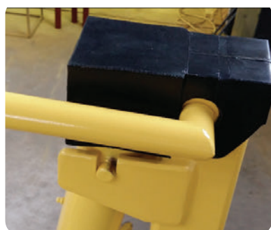
Foto 16. Tampa de proteção.
