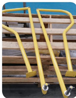
Foto 3. Corrimão da escada pantográfica.
