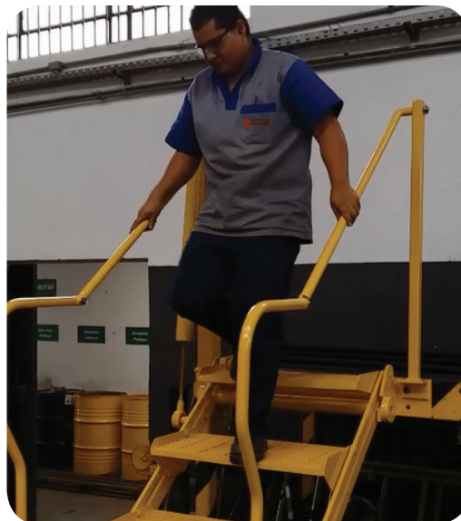
Foto 12. Escada travada pelo pedal.
